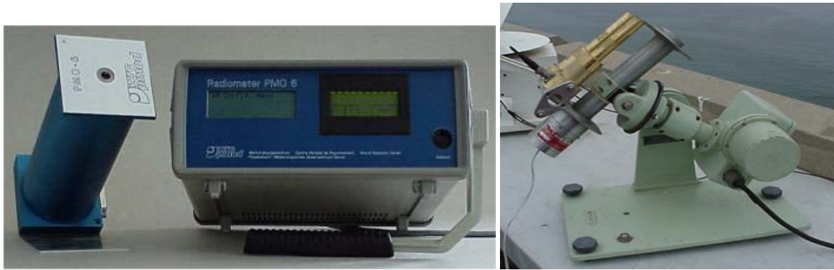
Figura 1.9. Pirheliómetro de cavidad Absoluta, serie PMO-6, y Pirheliómetro Eppley de incidencia normal (montado sobre un seguidor de sol). (Fuente: IDEAM).
